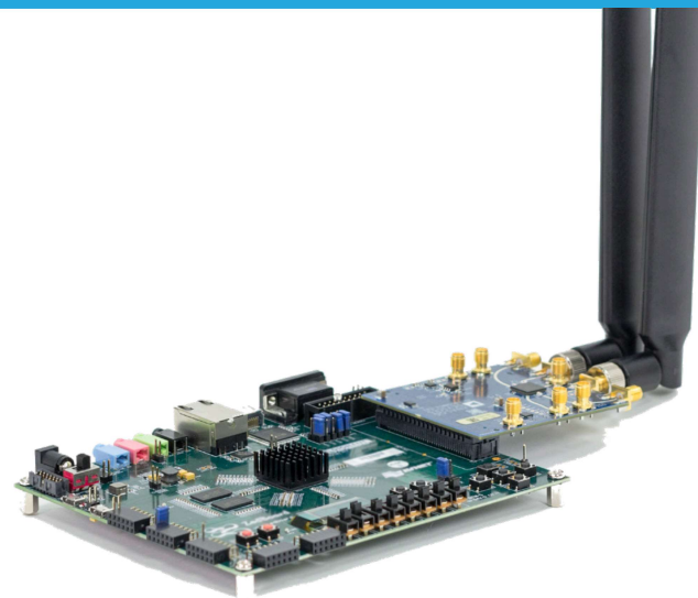
RFフロントエンドとFPGAボードのある一般的なSDRデバイス。
