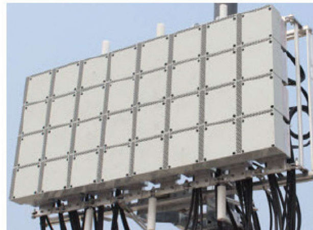
Huawei 5G 実施試験のための Massive MIMO アンテナ アレイ。
