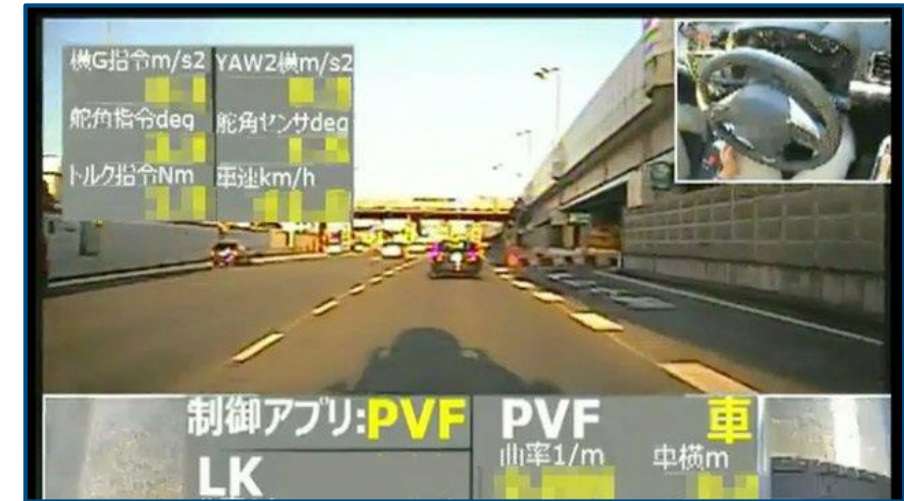
モデル予測制御を使用したACCアルゴリズムの公道テスト
