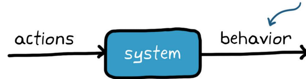
フィードバック制御システムでは、コントローラーは状態観測を使用してパフォーマンスを向上し、ランダムな外乱と誤差を修正します。エンジニアは、そのフィードバックをプラントと環境のモデルとともに使用して、システム要件を満たすコントローラーを設計します。
