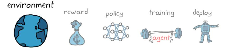
シミュレーション環境は、エージェントのトレーニングに最も一般的な方法です。制御問題に関するメリットの1つは、一般的に従来の制御設計ではシステムと環境のモデルが必要とされるため、通常すでに最適なモデルがあることです。MATLAB® または Simulink® で構築されたモデルがすでに存在する場合は、既存のコントローラーを強化学習エージェントに置き換え、環境に報酬関数を追加して、学習プロセスを開始できます。
